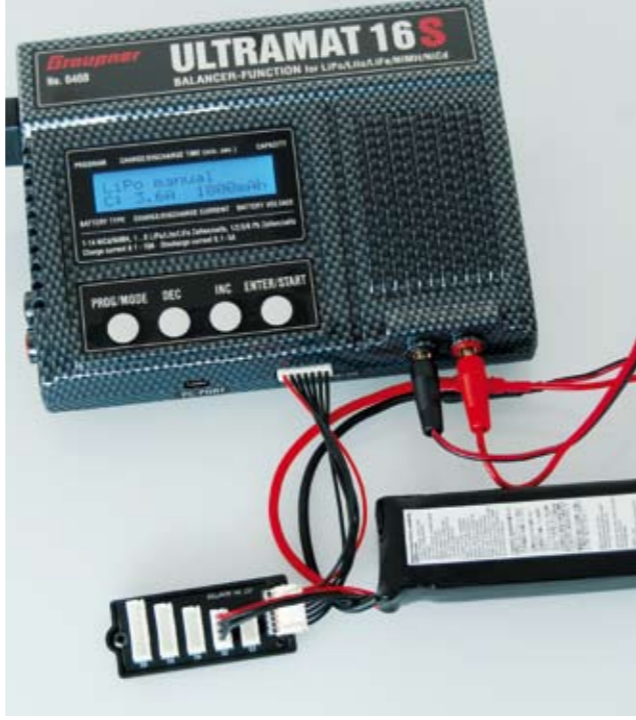
Über die vier Menü-Tasten lässt sich das Ultramat 16 S ganz easy programmieren
