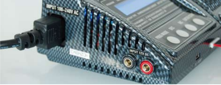
Angeschlossen am 220-V-Netz stehen 90 W Ladeleistung bereit. 150 W werden es bei Anschluss an einer 40-A-Autobatterie oder 15-A-Netzteil
