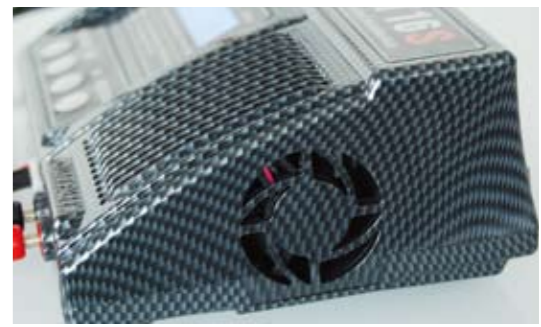
Sobald der Ladevorgang im LiPo-Modus startet, beginnt der Lüfter deutlich hörbar seinen Dienst
